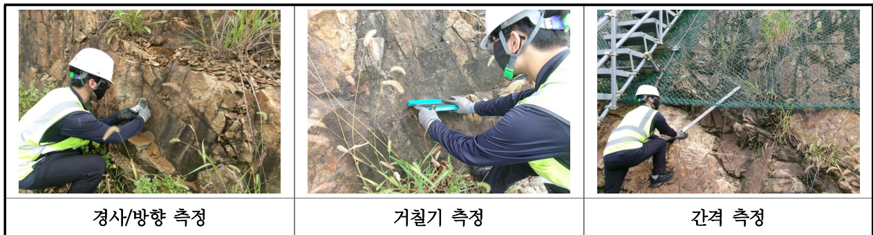
【사진 5.3.3】 불연속면 측정 현황
